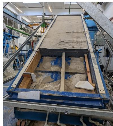
Obr. 2 a) 3D model svahu na laboratorním DS s označenými referenčními terči a identickými body v ploše, b) Uspořádání laboratorního dešťového simulátoru, kotvení lamel
