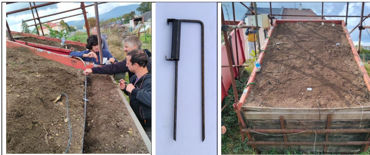
Obr. 3 Instalace senzorických lamel v lokalitě Jirkov: a) usazení senzorické lamely do půdního profilu, b) kotva pro uchycení lamely do hlubších půdních vrstev, c) experimentální plocha připravená pro měření pohybu svrchní půdní vrstvy včetně osazených a zaměřených fotogrammetrických terčů.
